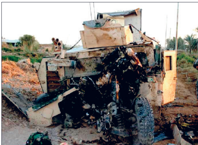
Fot. 86. Skutki działania IED na pojazd HMMWV, ładunek umieszczony na poboczu drogi.
