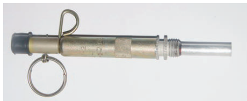
Fot. 108. Zapalnik składający się z: mechanizmu uderzeniowego MUW-2 oraz zapalnika MD-5M (z zawleczką P np. do miny POMZ-2M).
