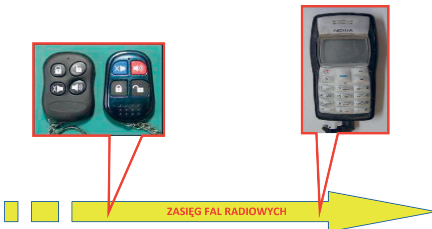
Rys. 47. Urządzenia wykorzystywane do radiowego sterowania wybuchami.
