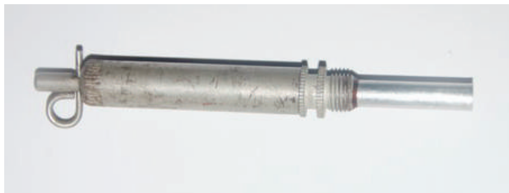
Fot. 125. Zapalnik o działaniu odciągowym do miny MON-100 składający się z: mechanizmu uderzeniowego MUW z i zapalną MD-5M.
