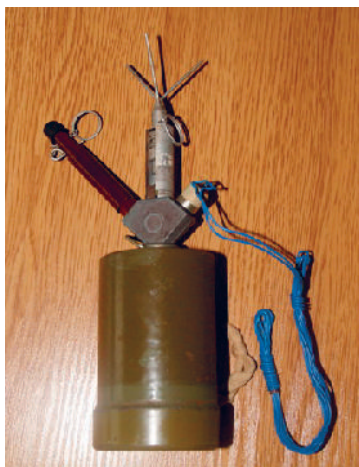
Fot. 119. Mina PSM-1 z trzema rodzajami zapalników.
