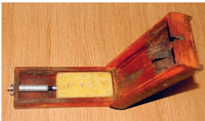
Fot. 109. Mina PMD-6M.
